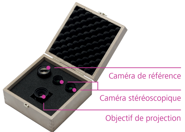
Kit d'extension pour un champ de mesure supplémentaire, composé de quatre objectifs.
